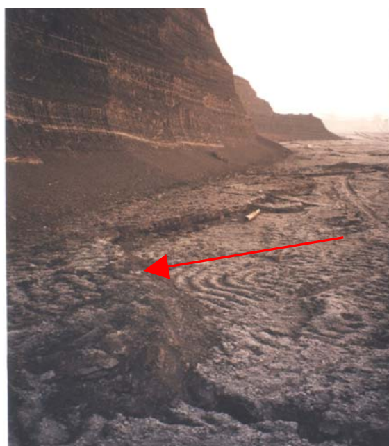
Obr. 20. Výchoz kluzné plochy u paty uhelného řezu. Fig. 20. Output of a slide plane at the coal cut foot.
