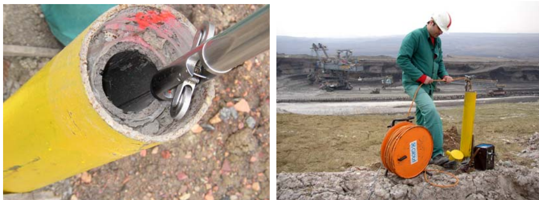
Obr. 18. Měření v inklinometrických vrtech. Fig. 18. Measurement in inclinometric drill holes.
