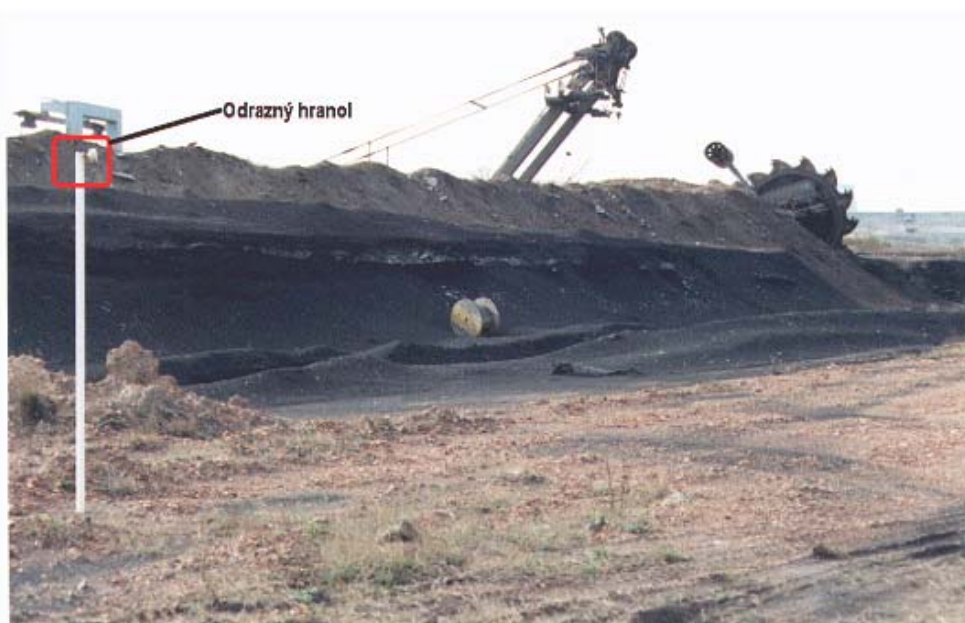
Obr. 17. Sledovaný kontrolní bod. Fig. 17. Monitored check point.
