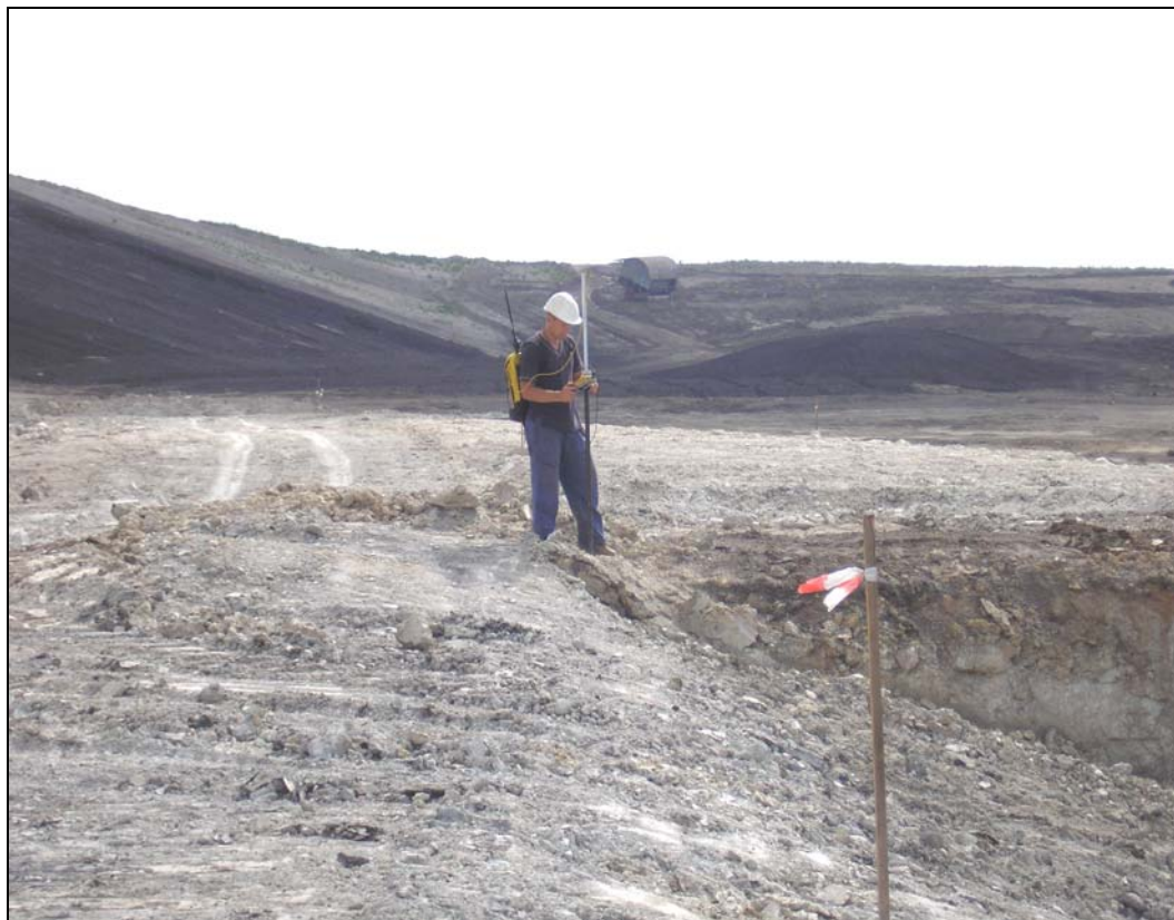
Obr. 16. Princip metody GPS – RTK. Důlní měřič vytyčuje pomocí mobilní aparatury GPS terénní úpravy na závěrných svazích. Fig. 16. Principle of the method GPS – RTK. Mine surveyor is settling out by means of using of mobile equipment GPS for terrain arrangements on definitive slopes.
