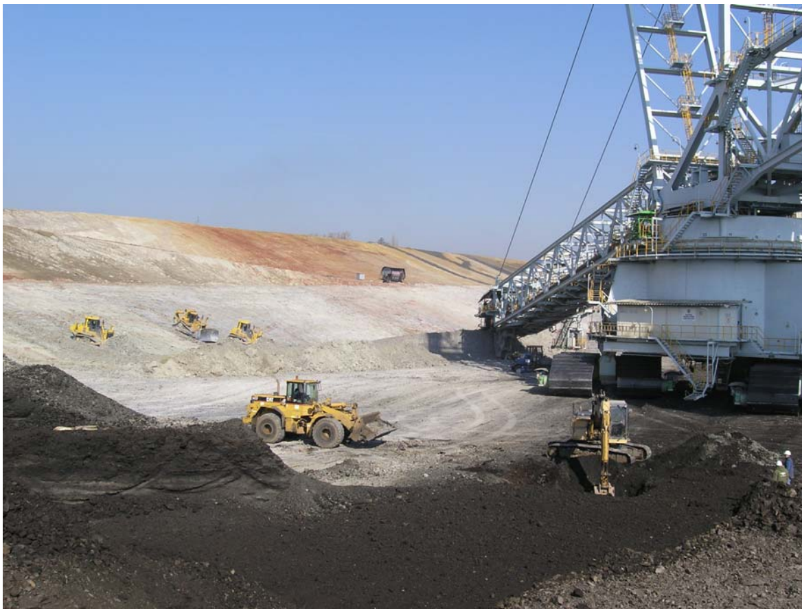
Obr. 15. Tvarování závěrných svahů – rýpadlo SchRs 1550 ve smíšeném řezu. Fig. 15. Formation of definitive slopes – the navy SchRs 1550 in a mixed cut.
