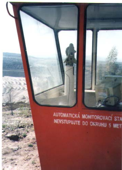
Obr. 22. Automatická monitorovací stanice. Fig. 22. Automatic monitoring station.
