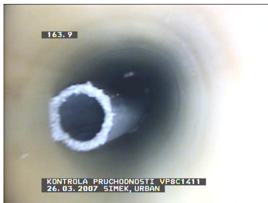
Obr.3 Ukázka TV prohlídky na vrtu VP8C1411 – přítomnost PVC hadice ve vrtu.
