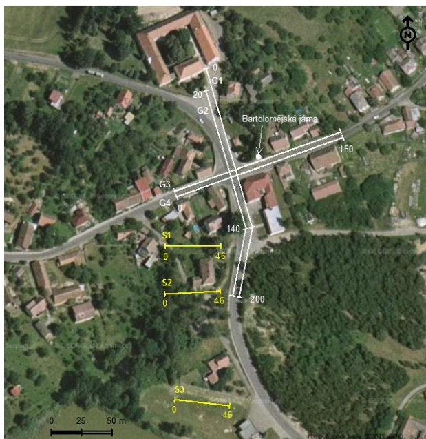
Obr.2 Situace geofyzikálních profilů. S1 – S3 seismické profily, G1 – G4 gravimetrické profily.
