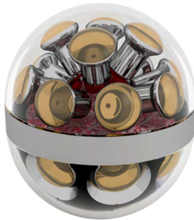
Abbildung III.4.3: Design eines Lichtsensors für zukünftige Neutrinoobservatorien, entwickelt an der Universität Erlangen und am DESY.
