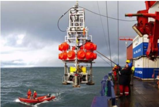
Vom Abend des 04.09. bis zum Morgen des 05.09.2017 wurde zum zweiten Mal auf dieser Ausfahrt das neue robotische System MANSIO-VIATOR getestet (Abb. 5). Dieses in der HGF-Allianz ROBEX entwickelte System, welches aus dem Tiefseecrawler „VIATOR“ und einem fixen Lander „MANSIO“ besteht, wurde erstmals in einer Tiefe von 1276 m am Vestnessa Ridge westlich von Svalbard getestet. Nach einer Erkundung mit dem ROV Kiel 6000 vom GEOMAR konnte das Gerät punktgenau abgesetzt werden.
