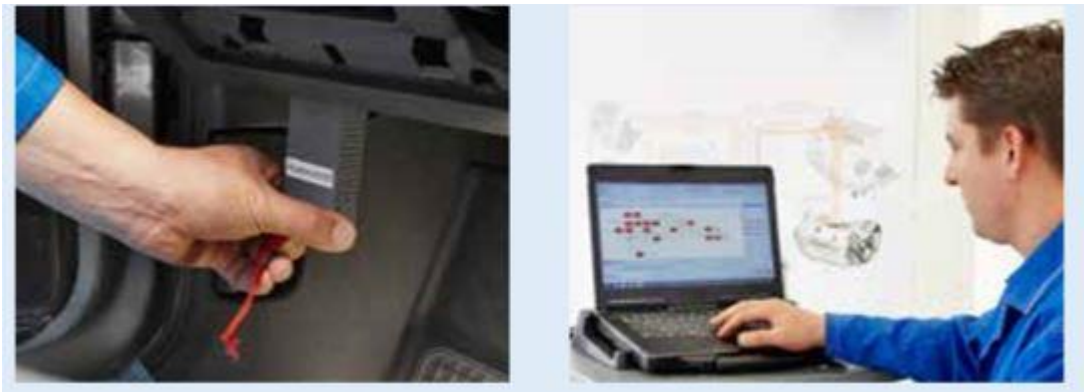
Figura 4.3: disinserimento indiretto mediante strumento diagnostico. SUVA-CFSL [18]
