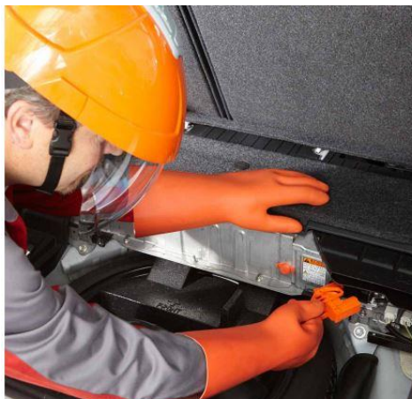
Figura 4.2: Operatore con appositi DPI che scollega il connettore di servizio. SUVA-CFSL [8]
