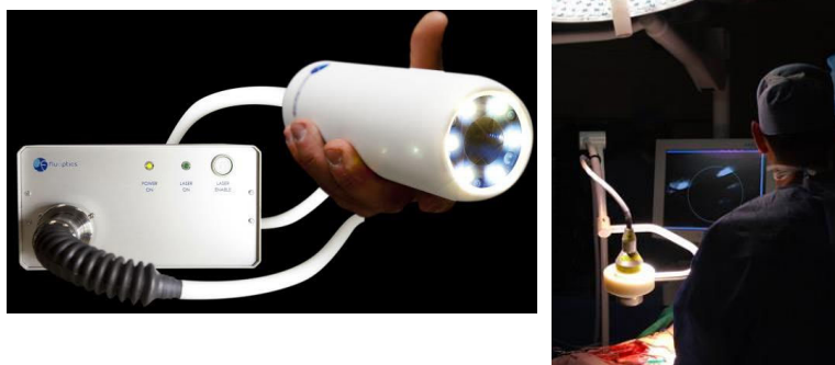
Figure 44 : (gauche) Présentation de la sonde : l'instrument est constitué d'un boîtier de contrôle et d'une tête (caméra et éclairage) reliés au boîtier par un câble pouvant être déconnecté. Le système est relié à un ordinateur. (droite) Sonde en situation lors de chirurgie sur gros animaux
