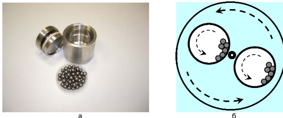
Рис. 1. Контейнер планетарной шаровой мельницы (а) и схема движения в ней (б). Внешний диаметр цилиндра на рис. 1, а, составляет 50 мм
