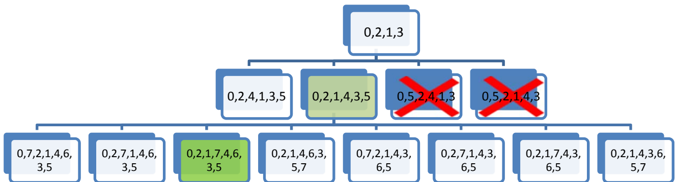
Figura 4.13. Esquema del branch and bound complet per a un cas de 2 peces i 3 tancs (font pròpia)
