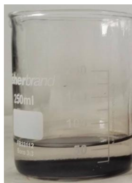
Figura 4-27: Aigua colorada amb 150mg/L d'Àcid Black 58 un cop tractada amb PM ( Mn_{70}Al_{30} )
