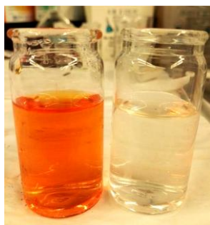
Figura 4-2: Aigua colorada amb 40mg/L d'Orange II (Esquerra) i aigua decolorada un cop tractada amb PM (dreta).
