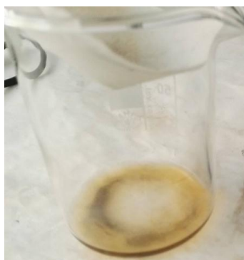
Figura 4-15 : Imatge del líquid del rentat de partícules amb Aigua i Etanol després d'haver-les assecat quan ja havien fet el tractament de decoloració d'Orange II.
