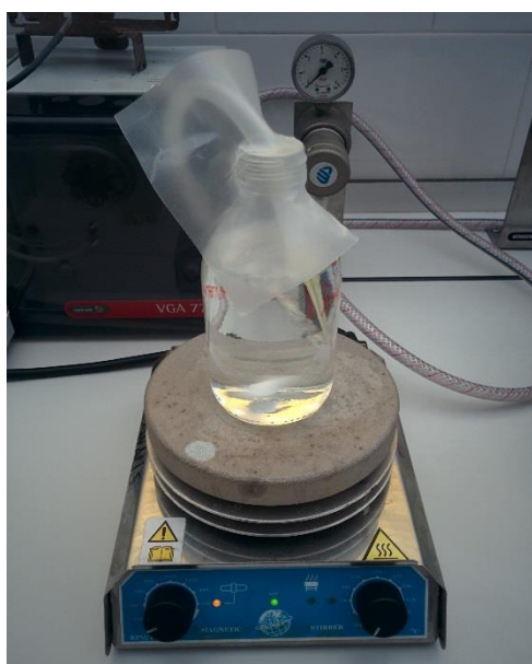
FIGURA 1: Extracción del O 2 incorporando N 2 en las disoluciones utilizadas para la obtención de los cristales
