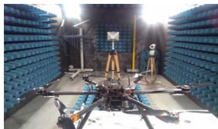
Fig. 5.12. Dron 3 colocado en la cámara con la antena más directiva y que emite a frecuencias más elevadas colocada para empezar la prueba.
