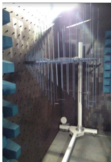
Fig. 5.10. Antena 2 de la cámara anecoica.
