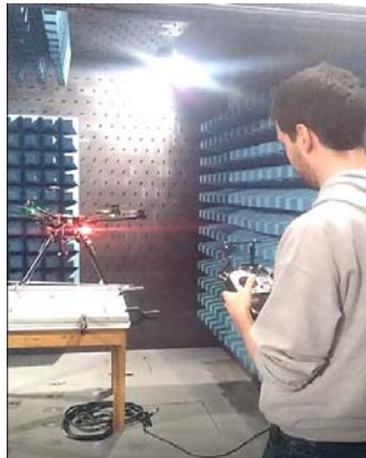
Figura 5.13. Dron 2 en vuelo en la cámara anecoica.
