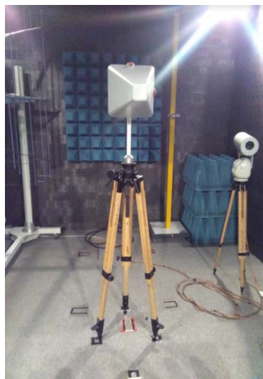
Fig. 5.9. Antena 1 de la cámara anecoica.
