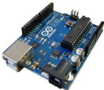
(Fig.A2.50) Micro. Atmega en format DIP (Fig.A2.51) Micro. En format SMD
