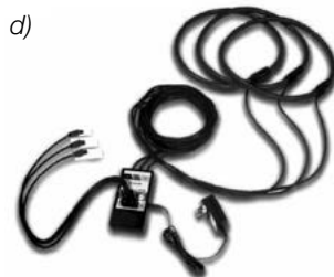
Figura 10.14. Analitzador elèctric AR6 + accessoris. a) Analitzador de xarxes, b) Pinça amperimètrica rígida CPR-500, c) Pinça amperimètrica flexible C-flex, d) Muntatge de les pinces C-Flex.
