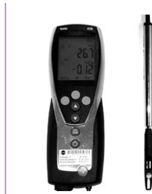
Figura 10.11. Multímetre TESTO 435 + sonda tèrmica de velocitat de fil calent.
