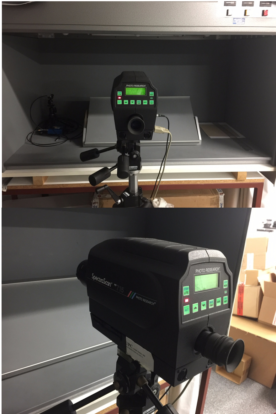
Figura 56 – 57. Imatges de l'espectroradiòmetre
