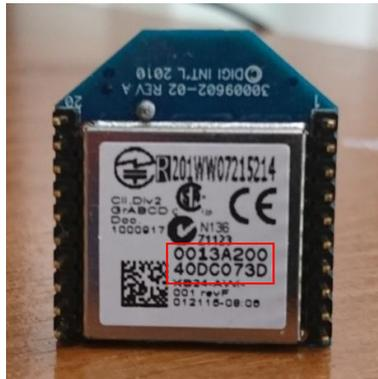
Figura 3.8 @MAC extensa de un módulo XBee.
