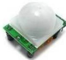
Figura 3.2 Sensor de presencia PIR
