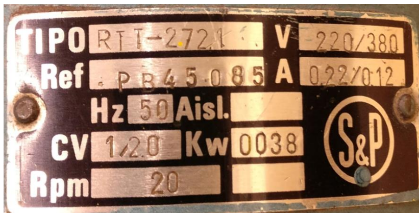
Figura 6-5 Placa de característiques del motor del autotransformador monofàsic regulable motoritzat.
