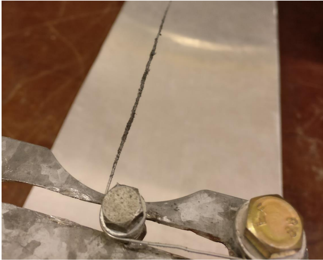
Figura 6-34 Conductor amb brutícia per realitzar l'assaig.
