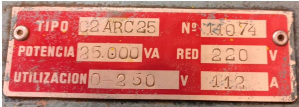
Figura 6-4 Placa de característiques del autotransformador monofàsic regulable motoritzat.
