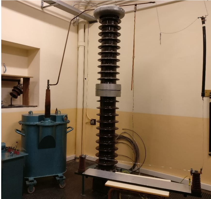
Figura 6-32 Muntatge i bancada de l'assaig de 4 conductors agrupats.
