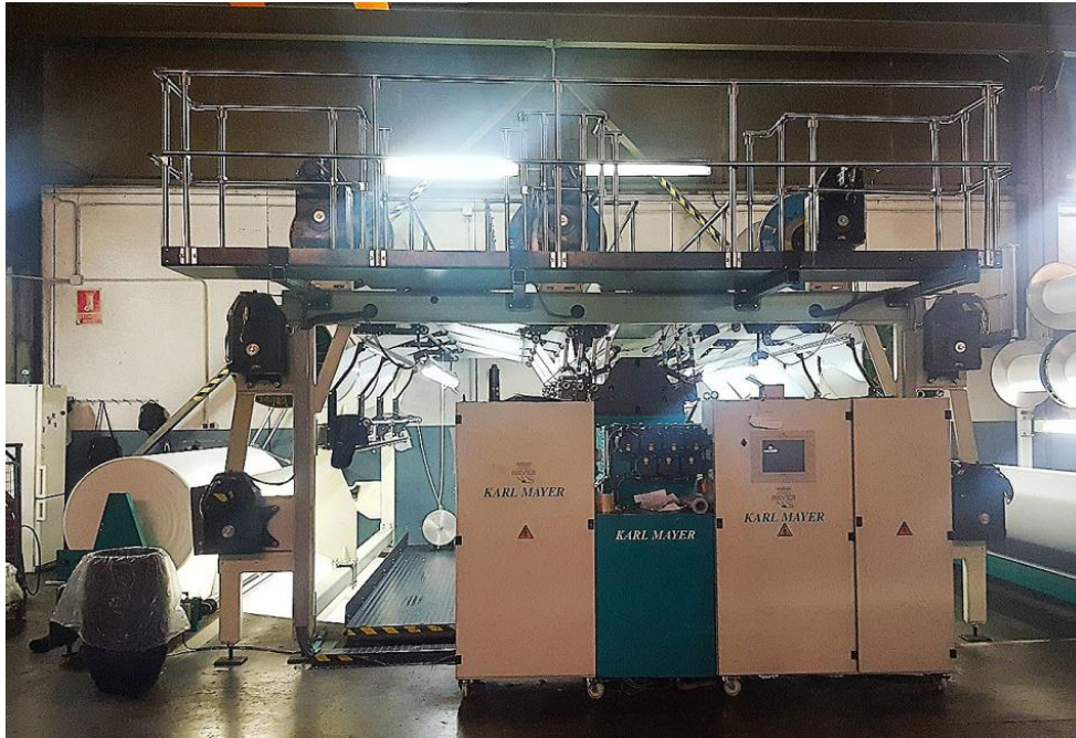
Figura 5: Teler Raschel “RD 7/2-12 EL” Font: Pròpia
