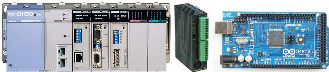
Figura 20: Exemple d'un PLC modular, un compacte i una placa Arduino
