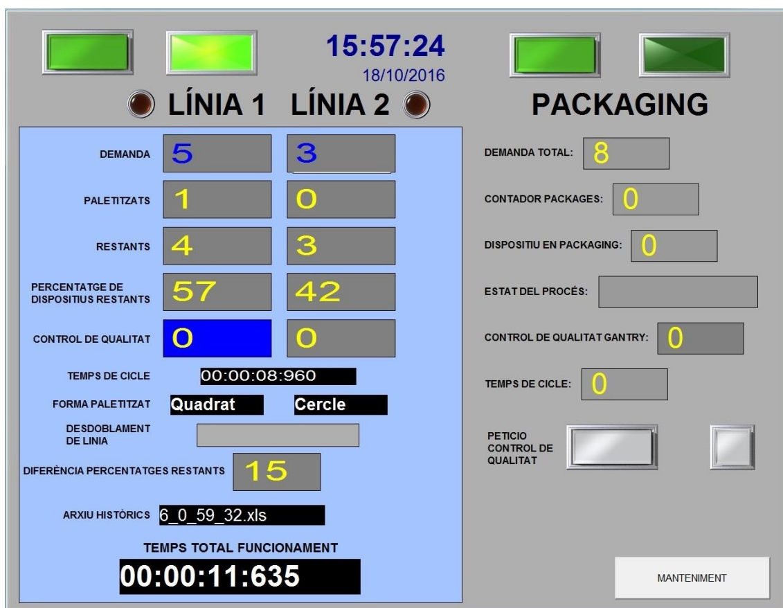
Figura 97: SCADA-Paletitzat amb petició de control de qualitat
