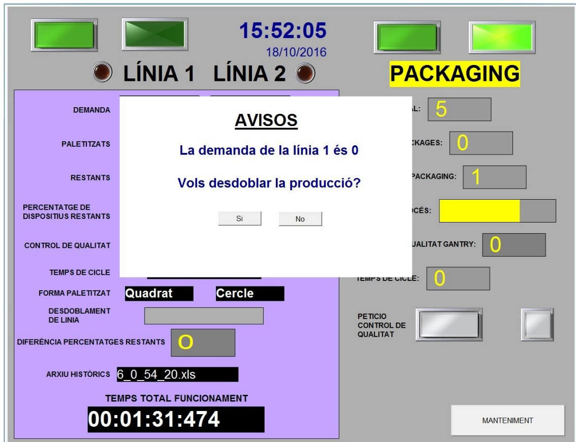
Figura 94: SCADA-Paletitzat amb desdoblament de línia 1
