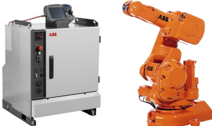
Figura 2: Controladora IRCS amb FlexPendant i el robot IRB 140 de ABB
