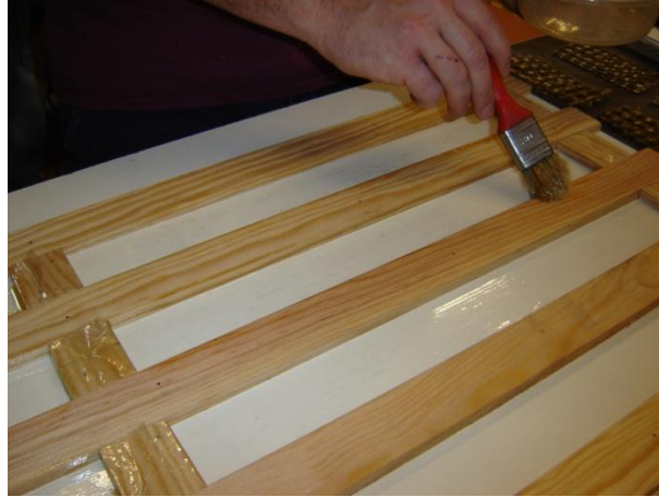
Figura 16. Aplicació d'oli al motlle.
