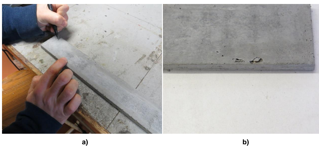
Figura 25. Marcatge provetes: a) Indicació material i data i b) Defecte provetes
