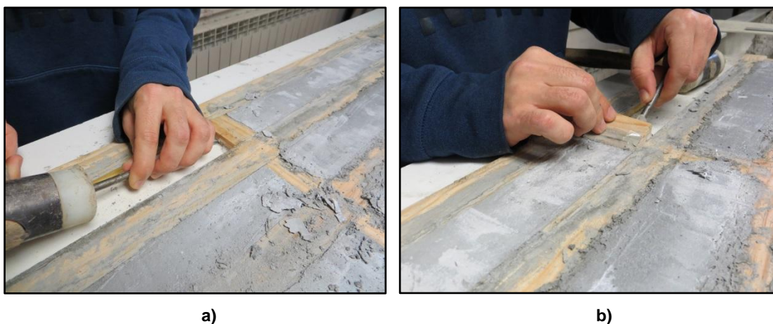
Figura 24. Extracció provetes: a) Inici extracció llistó i b) Extracció total llistó
