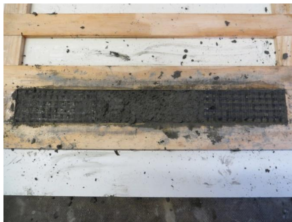
Figura 20. Aplicació tercera capa morter i fibra
