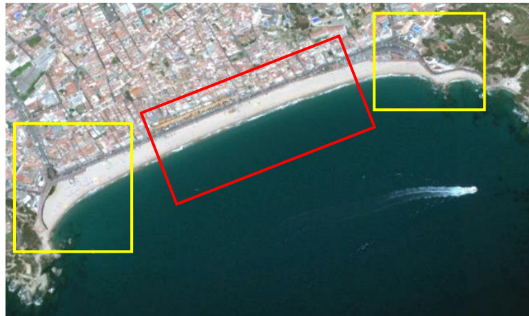
Figura 2. Diferents zones d'una platja encaixada. De color vermell la zona no afectada per la difracció (zona I) i de color groc la zona II on la difracció és present (forma parabòlica). Ortofoto del 18.05.2015 (Google Earth)
