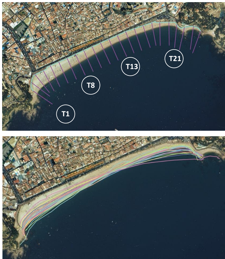
Figura 30. Inputs del software DSAS. En la imatge superior (a) apareixen els transectes en color lila i la línia base de color blau clar. En l'inferior (b) s'il·lustren les diferents línies de costa digitalitzades a partir de les ortofotos i imatges aèries
