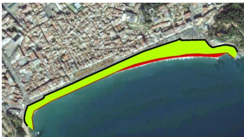
Figura 68. Replanteig de la línia de costa pel cas de març del 2014. De color llima l'àrea final i de vermell la que sobra després d'aconseguir que tota la platja tingui com a mínim 40 metres d'amplada
