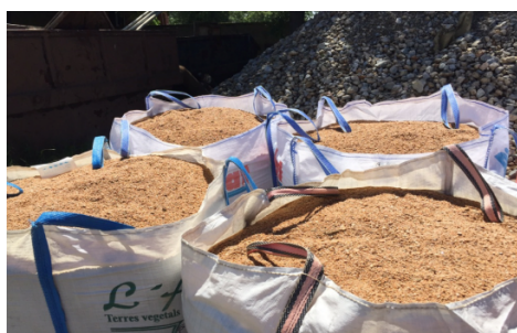
Figura 9. Materia orgánica utilizada para las barreras porosas reactivas avanzadas; a) grava de la costa mediterránea, b) compost vegetal (restos de madera, poda, entre otros)
