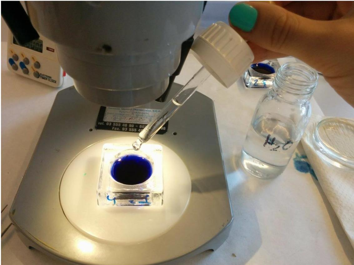
*Figura 14:* Proceso de dilución y lavado del azul de metileno, una vez transcurrido el tiempo de tinción.
