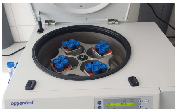
Figura 3-3. Mostres explotades de la Nannochloropsis gaditana introduïdes a la centrifugadora per la posterior concentració
