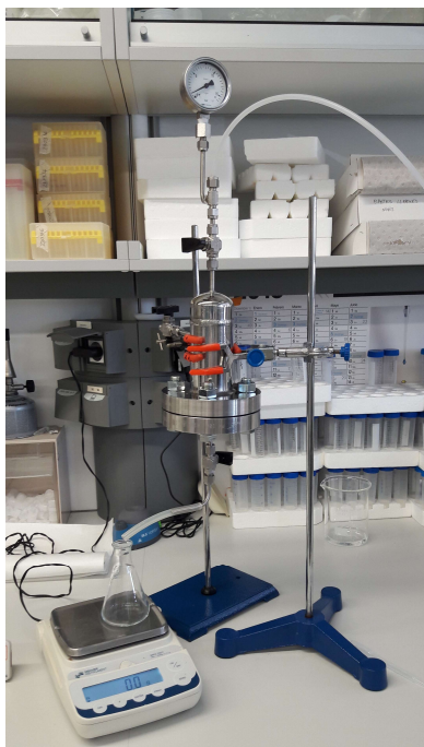
Figura 3-6. Equip experimental de filtració frontal que disposa l'Institut de Recerca en Energia de Catalunya (IREC)
