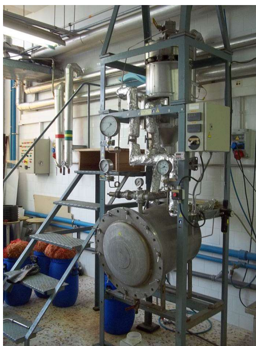
Figura 3-1. Equip experimental d'explosió de vapor situat a la Universitat Rovira i Virgili
