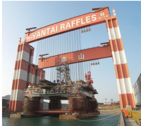
Imagen 11, grúa pórtico en Taisun, China, puede levantar hasta 20.000 toneladas.
