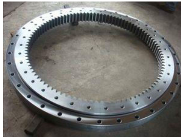
Imagen 52, Corona giratoria de gran tamaño similar a las usadas en las grúas torre.
