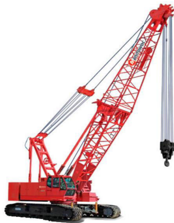
Imagen 9, grúa móvil de estructura reticulada.
