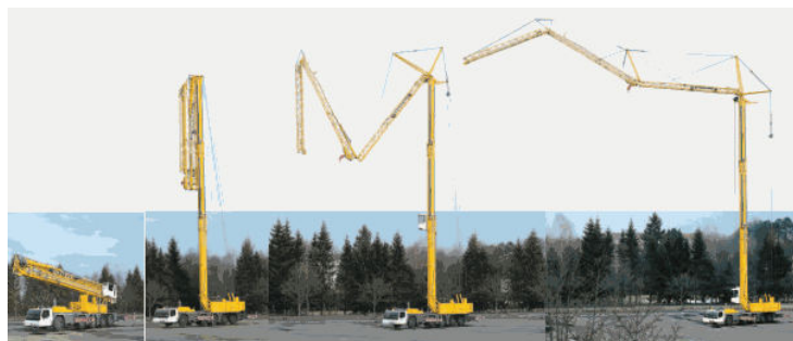
Imagen 6, serie de imágenes del despliegue de una grúa torre monobloc.
