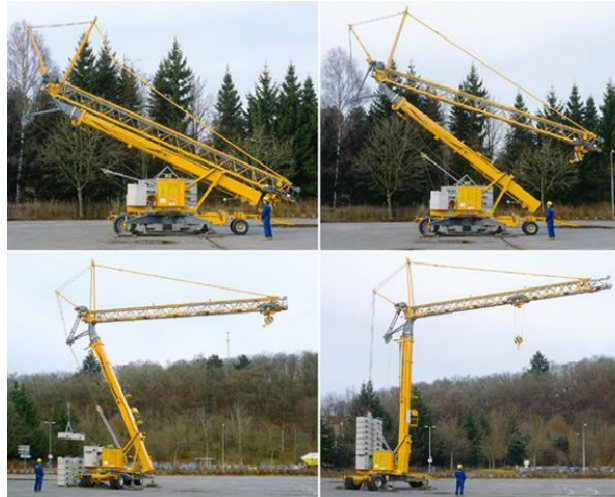
Imagen 5, procedimiento de despliegue de una grúa torre autodesplegable...
