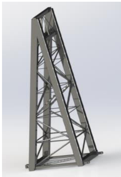
Imagen 153, Castillete modelizado con SolidWorks.
