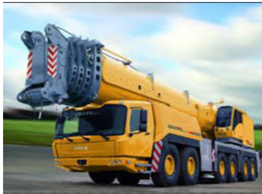
Imagen 8, grúa telescópica montada sobre un vehículo.
