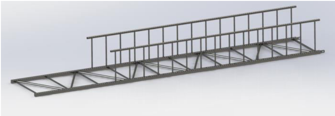
Imagen 152, Contrapluma según la modificación para el cálculo de uniones modelizada con SolidWorks.
