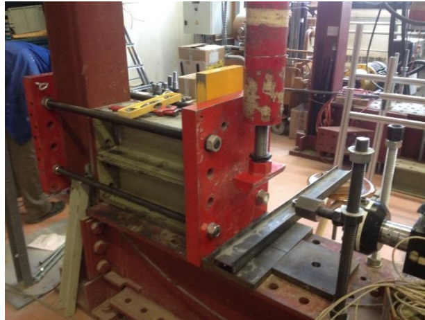
Figura 19. Elements addicionals col·locats per poder realitzar els assajos.
