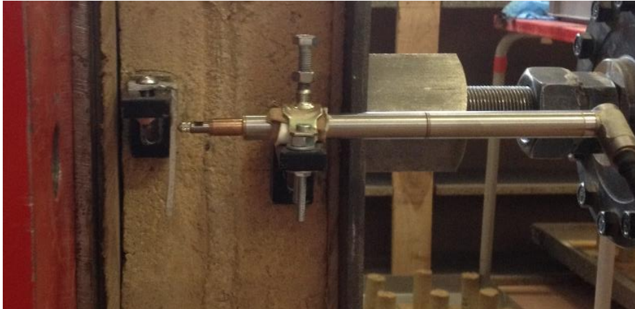
Figura 25. LVDT que mesura el desplaçament horitzontal.
