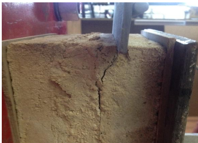
Figura 12. Element que aplica la força tallant clavant-se al maó
