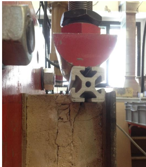
Figura 14. Perfil d'alumini utilitzat als assajos per evitar el trencament dels materials.
