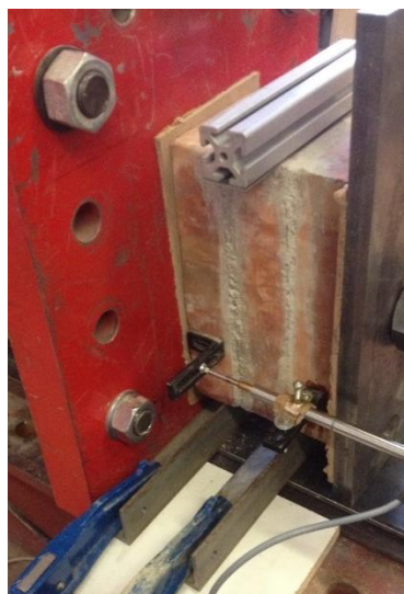
Figura 20. Perfils el L utilitzats per tenir les reaccions al tallant aplicat
