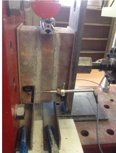
Figura 17. Configuración final de l'assaig de tripletes.
