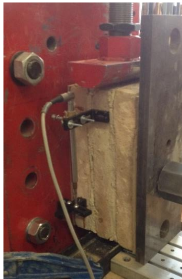
Figura 16. Configuració inicial de l'assaig de tripletes.
