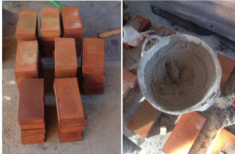
Figura 1. Maons (Esquerra) i morter (dreta) moderns utilitzats en l'experimentació.
