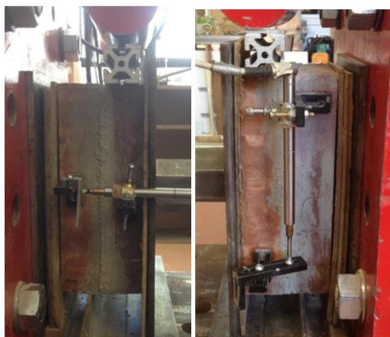
Figura 24. Posicionament real entre sensors.
