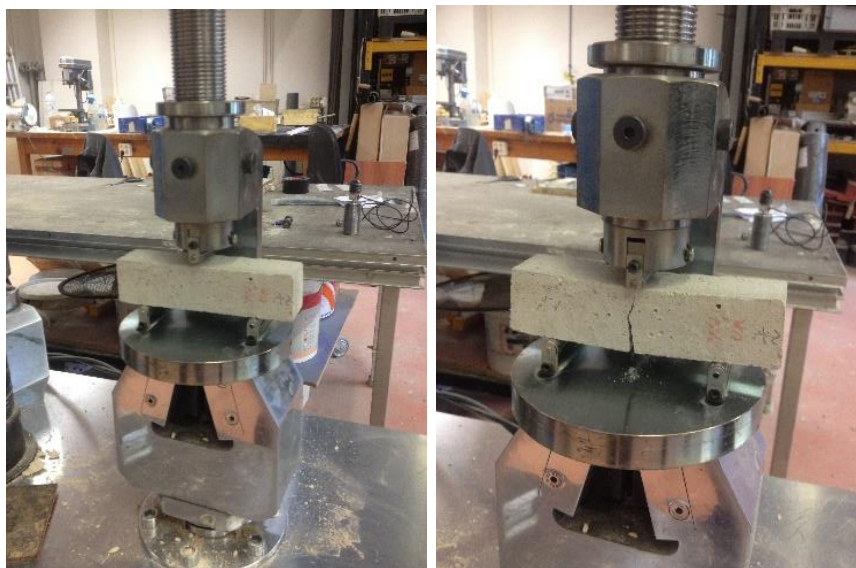
Figura 6. Inici i final de l'assaig de flexo-tracció
