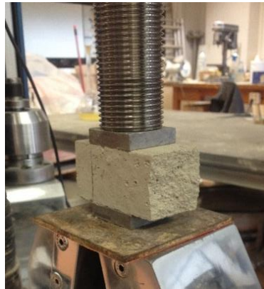
Figura 7. Assaig de compressió de morter
