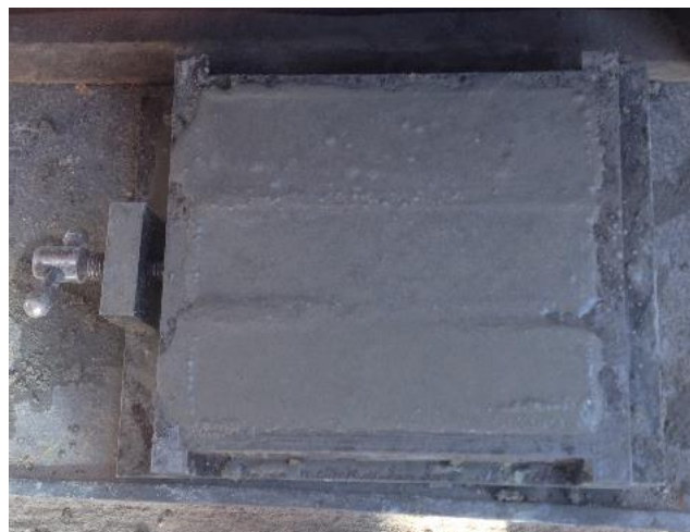
Figura 10. Mostres de morter en el motlle corresponent.
