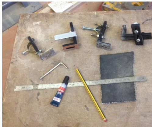
Figura 21. Elements utilitzats en la preparació d'una proveta per ser assajada.
