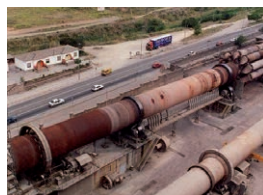
Forn rotatori per a la fabricació del ciment
