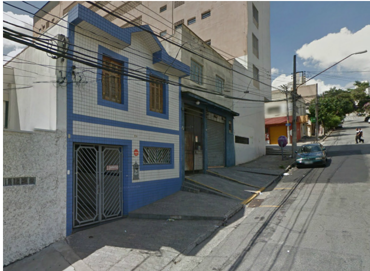
Figura 5. Desnivel en las aceras: esta característica recurrente en la ciudad de São Paulo dificulta el desplazamiento de personas con movilidad reducida. Fuente: Google Maps
