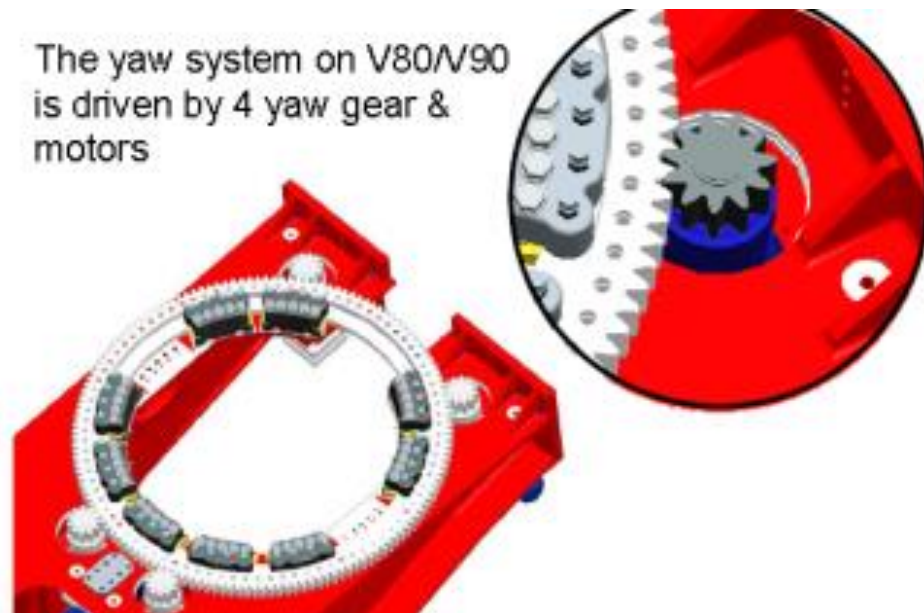
Fig. 7 Esquema del sistema de orientación para un aerogenerador Vestas V90 [10]
