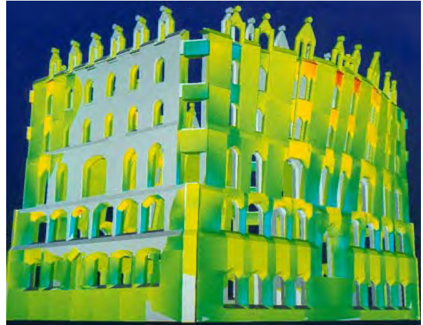
Figura 5.17. Tensiones normales producidas por un sismo, en rojo zonas con tracciones superiores a 1,0 MPa; en verde zonas comprimidas.
