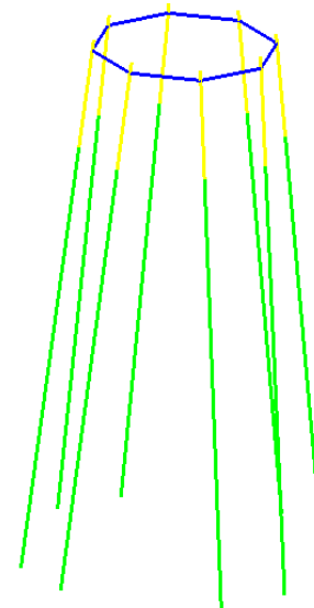
Figura 7.33 Elementos de cable según sus propiedades materiales
