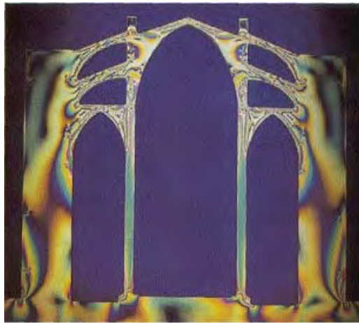
Figura 5.5. Modelo fotoelástico de la nave central de la Catedral de Mallorca(Mark, 1982)
