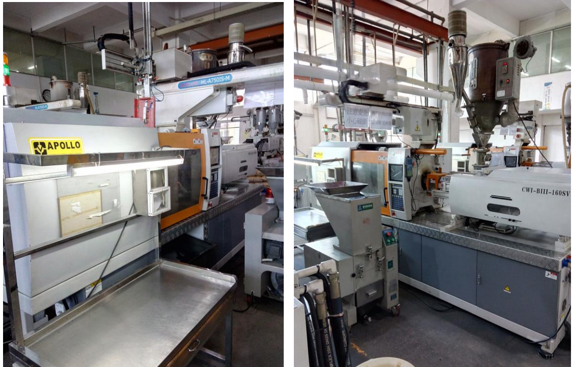
Foto 9. Dos fotografías de la maquinaria de inyección usada para realizar el muñeco Giftoy
