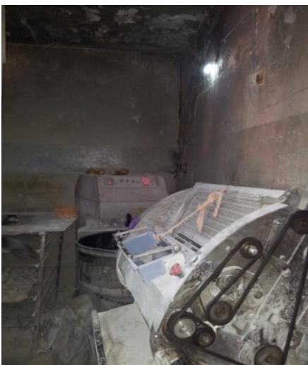
Fig.8: Manteniment precari de les màquines, llum sense protecció.
