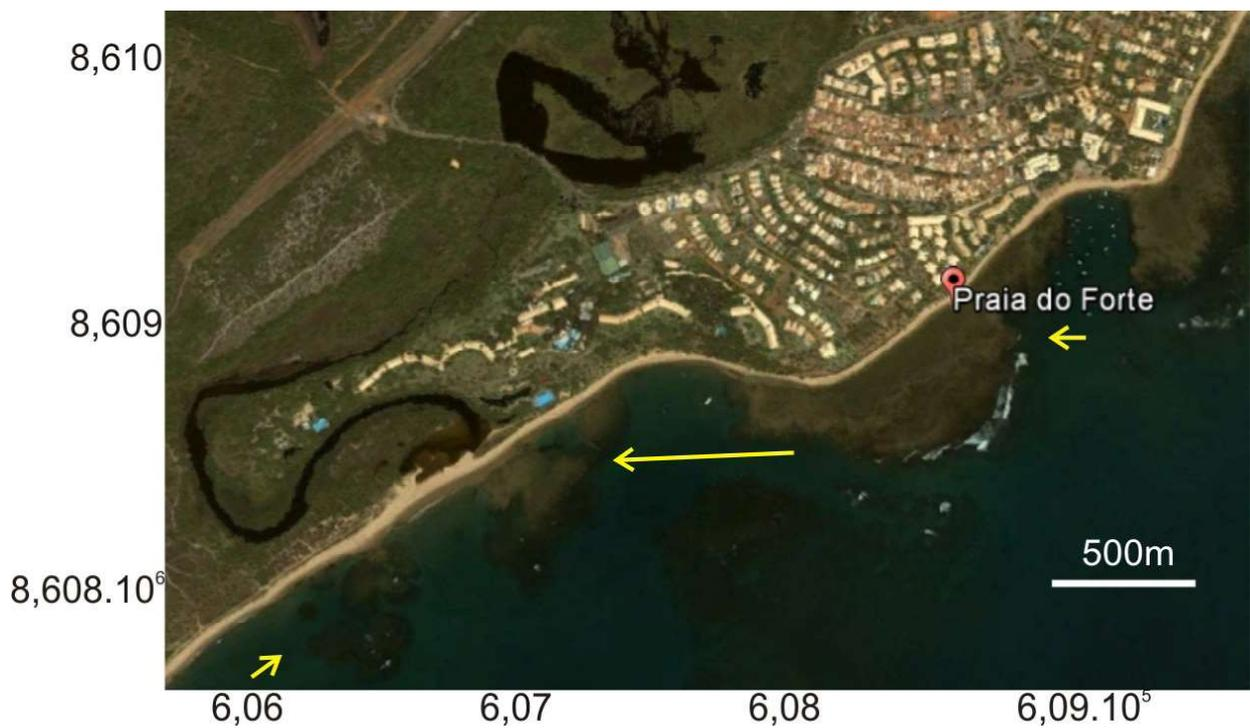
Figura 10 - Direção e magnitude do transporte de sedimentos no litoral da Praia do Norte.
