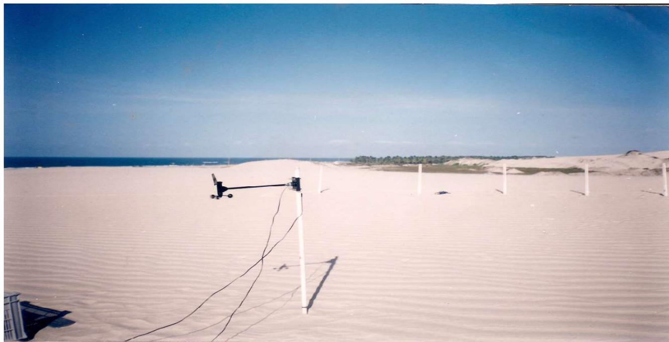
Figura 6 - Anemômetro para a medição de dados de vento, posicionado na margem inferior esquerda e centro da fotografia e armadilhas para sedimento eólico posicionadas à direita, na metade superior da foto. As armadilhas foram colocadas em uma duna de 15 m de altura e estão com aberturas perpendiculares à direção do vento.
