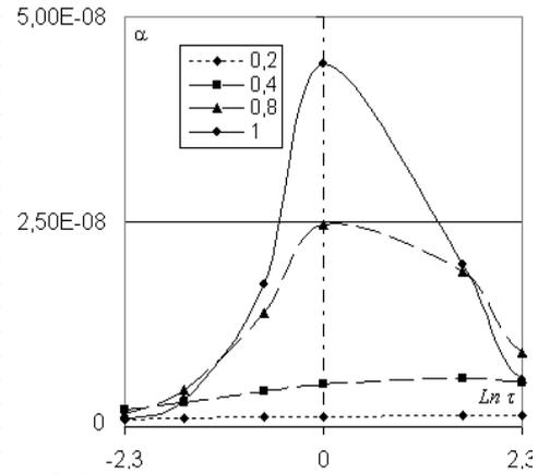
Рисунок 2. Зависимость коэффициента затухания от температуры
