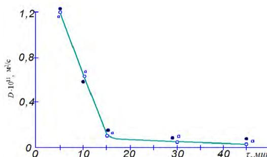
Рисунок 1. Изменение коэффициентов диффузии экстрактивных веществ в люпине в процессе экстрагирования (обобщённая кривая): ○ – пластина, ● – цилиндр, □ – крупка.
