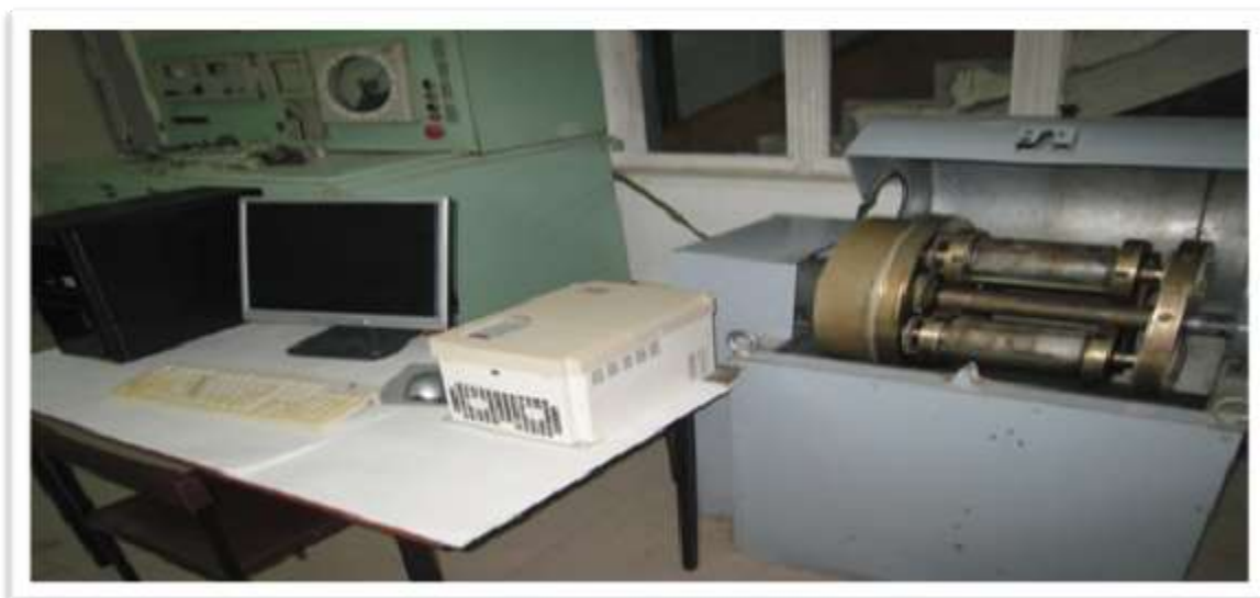
Рисунок 1 - Планетарная мельница «Активатор-4М» с инвертором Toshiba VF11-415OPL.400B,3Ф
