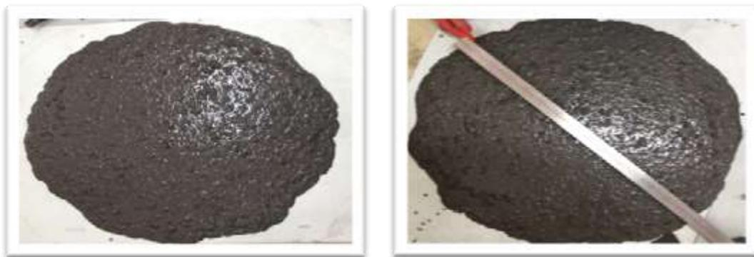
**Рисунок 3 – Определение диаметра растекания конуса SCC смесей**
