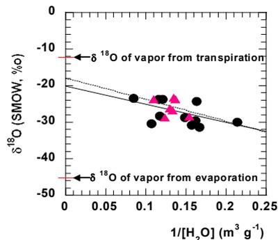
図2 キーリングプロットの一例。日中の大気中水蒸気の $\delta^{18}\text{O}$ と水蒸気密度の逆数との関係を高度別に表す(丸: キャンノピー上, 三角: キャンノピー内) 2003年8月21-23日のデータ。破線はキャンノピー上, 実線はキャンノピー内の線形回帰曲線。
