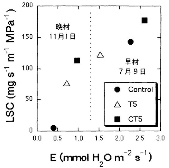
第2図 温度・CO<sub>2</sub>濃度勾配型ビニールハウス内の3処理区（外気温・外気CO<sub>2</sub>濃度区（Control）、+5℃昇温区（T5）、+5℃昇温・CO<sub>2</sub>濃度増区（CT5））で14ヵ月間栽培したシラカシ3年生稚樹の年輪のLeaf specific conductivity (LSC) とハウス内で実測した単位葉面積当たりの蒸散速度 (E) との関係
