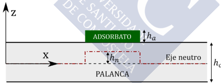
Figura 5.1. Cambio en el eje neutro debido a un adsorbato depositado en la superficie de la micropalanca. El eje neutro permanece inalterado, salvo en la zona donde se ha producido la adsorción, la cual se desplaza hasta la nueva posición z = h_n .
