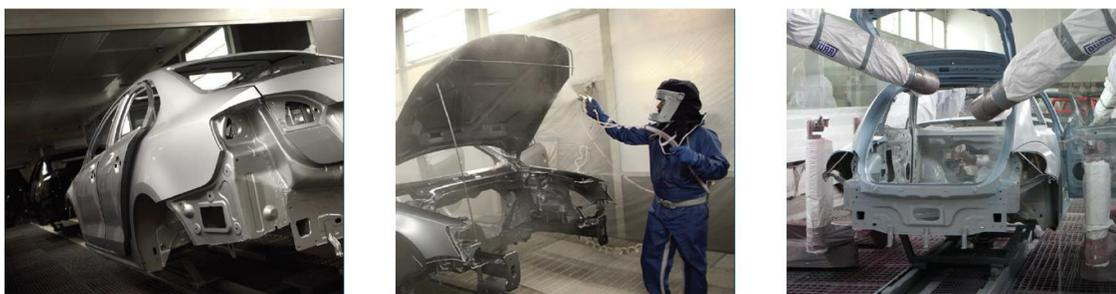
Imagen 3. *Proceso de pintura a base de agua. Proceso de pintura robotizada. Planta de Puebla Grupo Volkswagen de México.*
