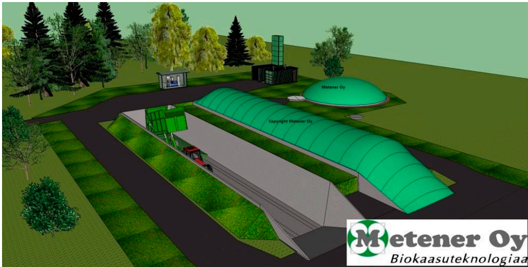
Kuvio 2. Havainnekuva Metener Oy:n kehittämästä, tuottamasta ja markkinoimasta kuivämädätyslaitoksesta, jossa kokonaisuus muodostuu kahdesta silosta, perkolaationestesäiliöstä, kaasun puhdistus- ja paineistusyksiköstä sekä tankkausasemasta. Kuva: Metener Oy.
