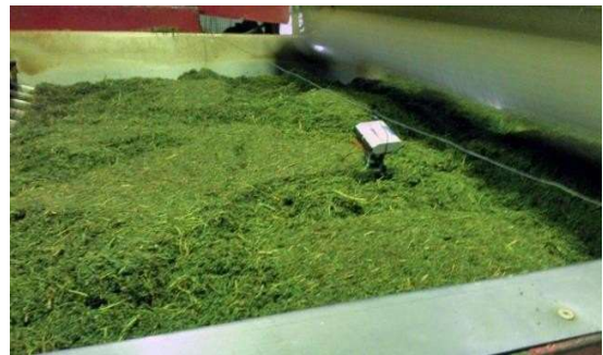
Figura 1. Cinta transportadora al final del proceso de enrutado y principio del proceso de fermentado. (Fotografía tomada en enero del 2015)
