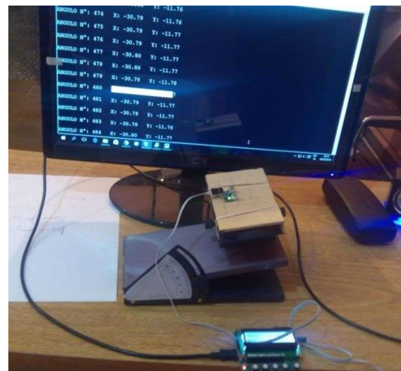
Figura 2. Prueba de funcionamiento sensor MPU-6050
