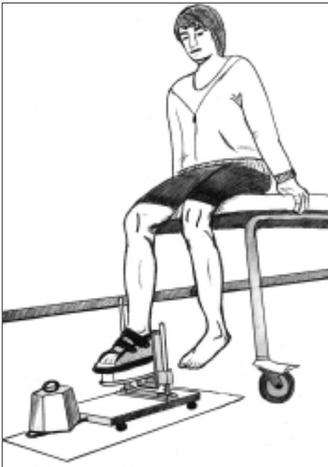
Bild 1a. Gesamtansicht der Versuchsanordnung mit einem Proband bei Messung der isometrischen Dorsalextension.
