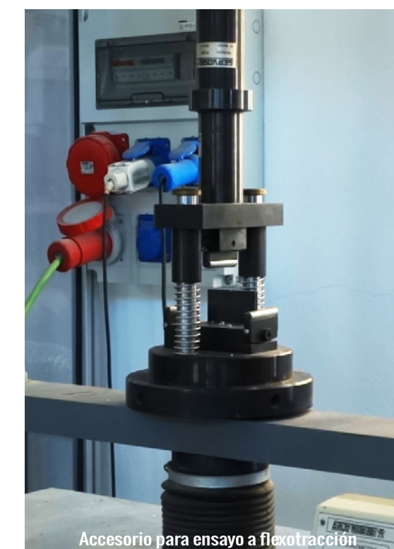
Accesorio para ensayo a flexotracción
