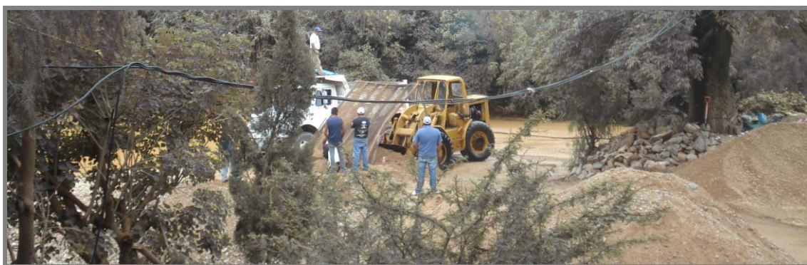
Fotografía 15. Extracción de arena en el cauce del río con maquinaria. Fuente propia.
