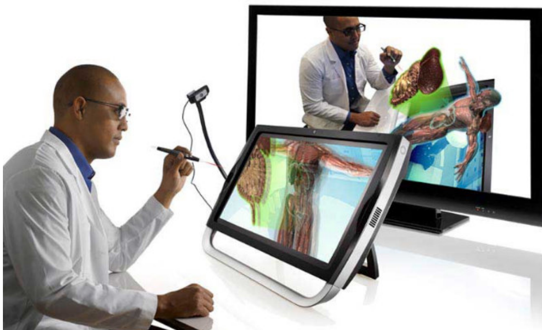
Abbildung 2-17: Screen VR (Bildschirm, Brille und Eingabestift) aus Sicht des Beobachters und des Nutzers (zSpace 2016b)
