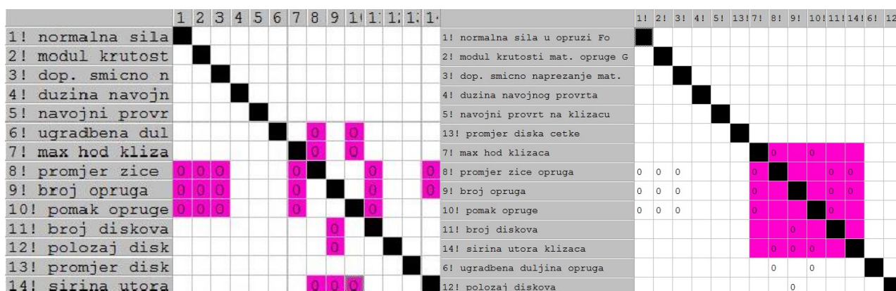
Slika 41: Partitioniranje parametara mehanizma za poliranje prirubnice u alatu PSM 32 (lijevo prije partitioniranja, desno nakon partitioniranja)
